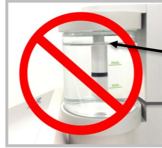
Şek. 5.2: Yanlış su seviyeleri (minimum ve maksimum arasında değil)
