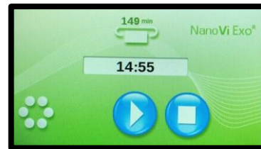
Şekil 8.9.1: "Duraklatmada kart oturumu"-kullanıcı-kartında ekran-"seçilebilir"-mod
