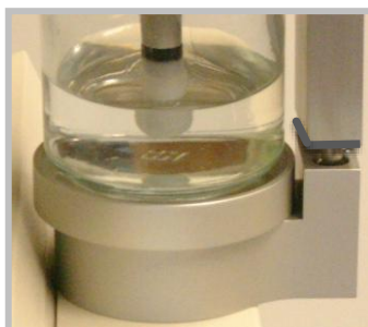
Fig. 5.3: Inserimento dell'umidificatore nel dispositivo
