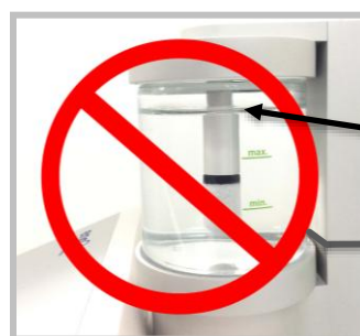
Fig. 5.2: Livello di acqua non corretto (non tra min e max)
