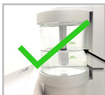
Fig. 5.1: Livello di acqua corretto (tra min e max)
