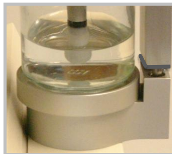
Abb. 5.3: Einstecken des Befeuchters in das Gerät
