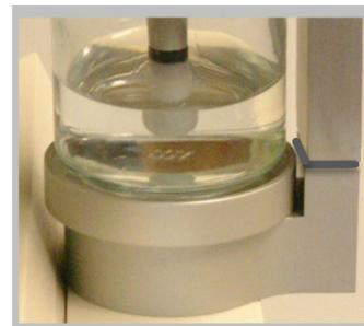
Fig. 5.3: Inserimento dell'umidificatore nel dispositivo
