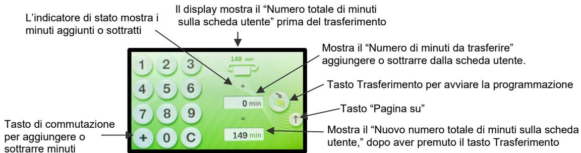
Fig. 8.16: "Schermata di programmazione"
