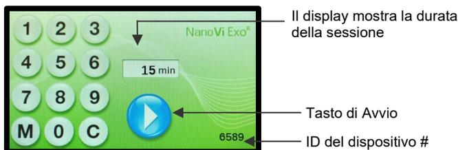
Fig. 7.2: "Schermata di input" in Modalità standard
