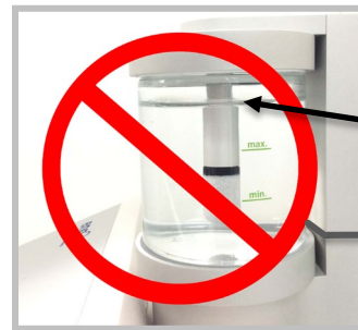
Abb. 5.2: Falscher Wasserstand, wenn nicht zwischen Min- und Max-Linie
