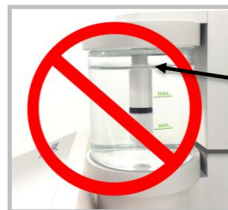
Fig. 5.2: Niveles de agua incorrectos (no entre min y max)
