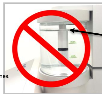
Fig. 5.2: Niveaux d'eau incorrects (pas entre min et max)
