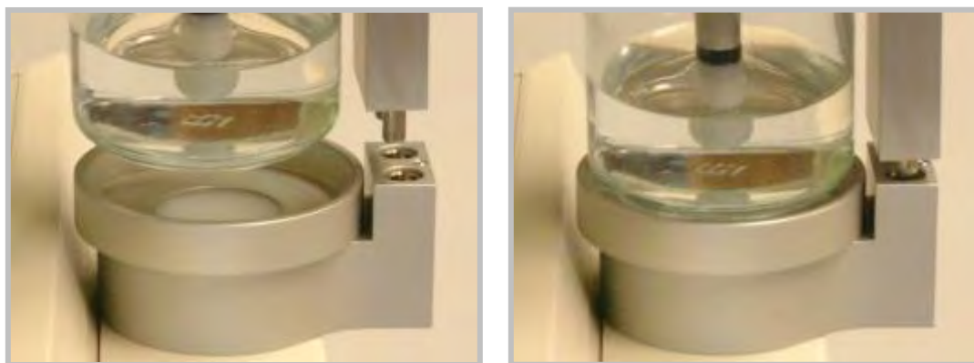
Figura 5.1: Inserimento dell'umidificatore nel dispositivo
