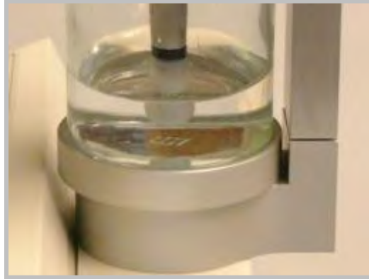
Figura 5.2: Corretto inserimento dell'umidificatore
